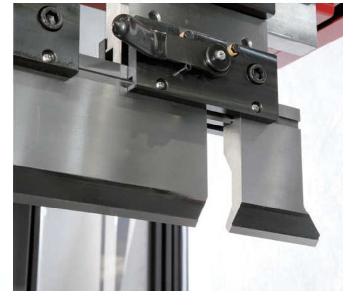
上金型落下防止キー付き中間板 (標準) Intermediate plate with key (Standard)
