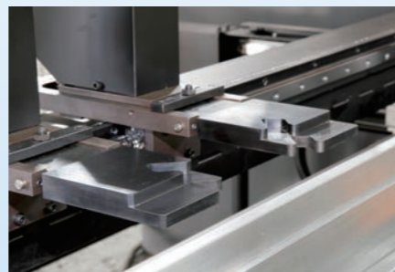
オプション カニ爪形突き当て Option crab-claw stopper
